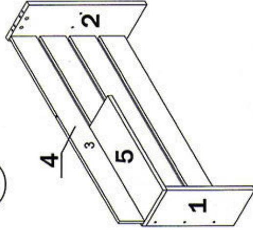
3. Забить шканты (1) в стенки задние 7 и 8 и соединить их с боковинами 1 и 2. Фиксацию полки 5 с деталью 8 произвести при помощи евроинтов (2).
