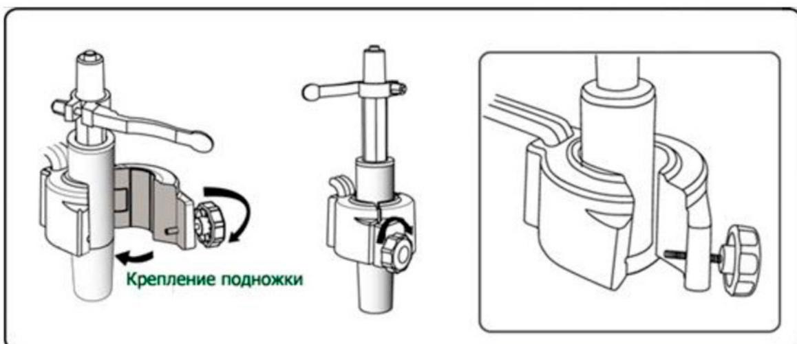
Когда рычаг поворачивается в направлении открыть, кресло DUOREST свободно вращается вокруг оси. Когда рычаг поворачивается в направлении закрыть, кресло фиксирует положение и его нельзя повернуть, что ограничивает вращение ребенка в кресле и способствует формированию правильной осанки.
