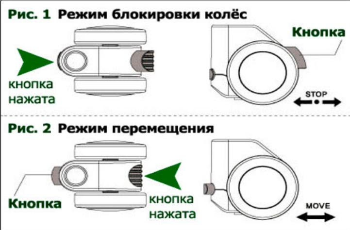
1. Когда Вы нажимаете кнопку блокировки, как показано на рисунке 1, движение колес блокируется в соответствии с нагрузкой по весу пользователя.
