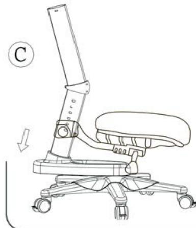
1. Вставьте опорную базу (A) и защитную накладку (B) в основание крестовины (C) кресла.
